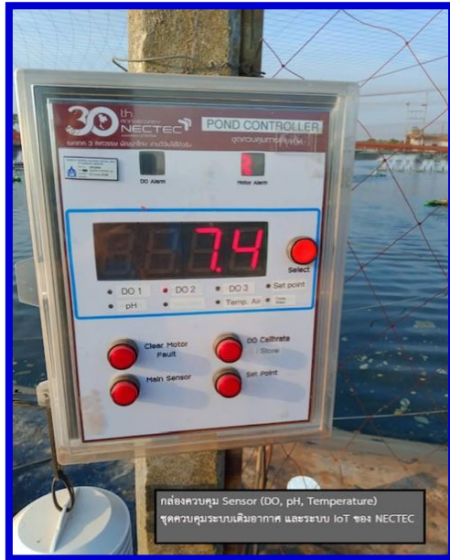
กล่องควบคุม Sensor (DO, pH, Temperature) ชุดควบคุมระบบเติมอากาศ และระบบ IoT ของบริษัท Hydro Neo
