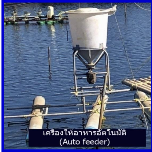
สะพานยอสำหรับติดตั้งตัว sensor และ Auto feeder
