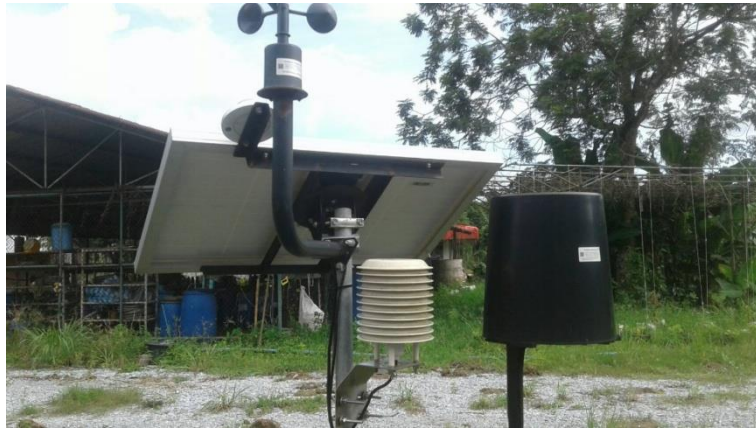
ระบบตรวจสอบสภาพอากาศแบบ real time โดยวัด อุณหภูมิ ความชื้นแสง และความเร็วลม
